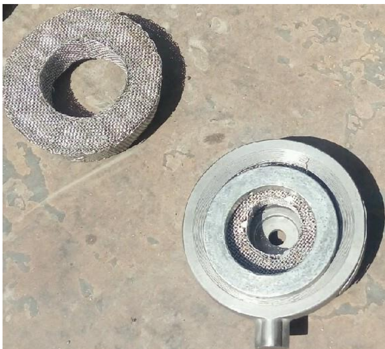
کیچ کلوژر و سایلنسر داخلی رگولاتور محوری
