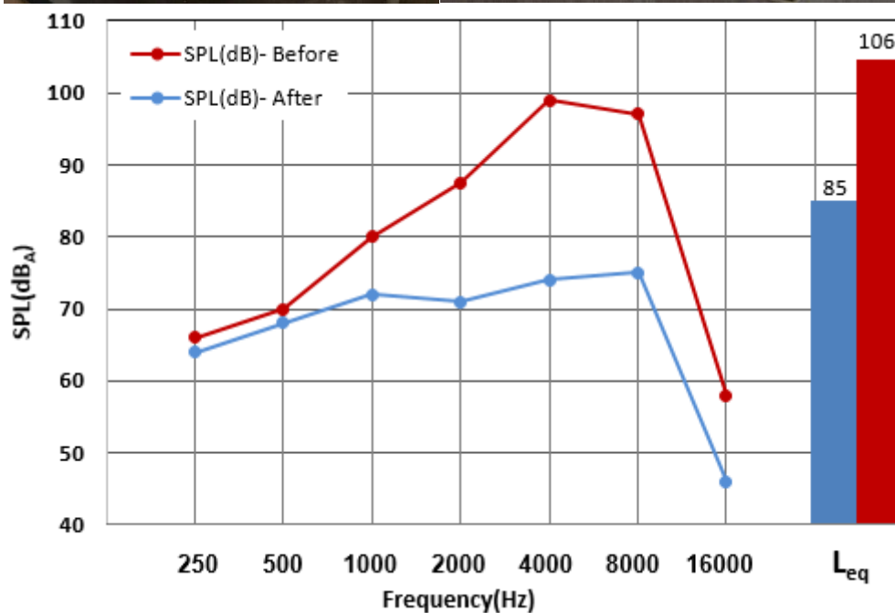
نمودار طیفی عملکرد آکوستیکی سایلنسر تخلیه چکش بادی
