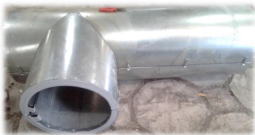
پوشش آکوستیکی باز شونده خروجی توربوپمپ نیروگاه
